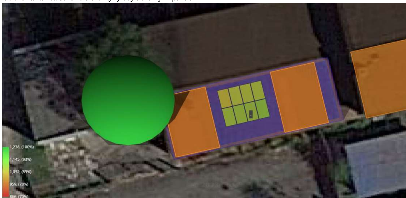
Obrázek č. 4.9.4.6: Schéma efektivity výroby elektřiny FV panelů
